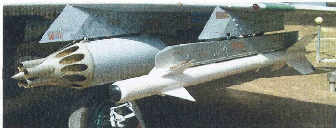
Zewnętrzny pylon pod skrzydłowy dla wersji MF i bis
