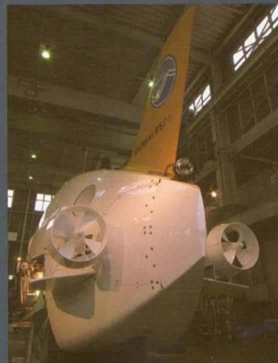
▲換装された主推進器。以前の主推進器があった部分にはFRP製の流線型のカバーが取り付けられた
