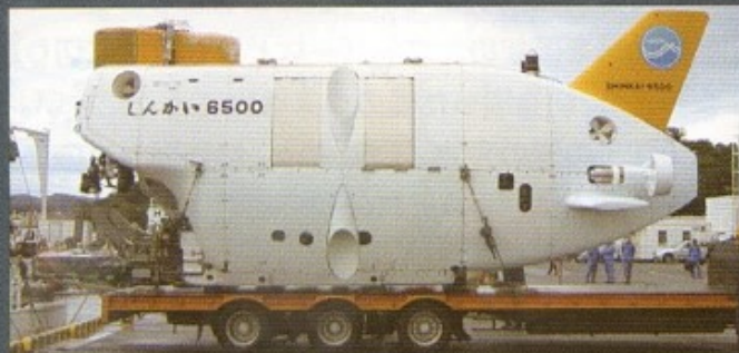
▲▼上の写真が改造工事後、下の写真が改造工事前のものである。比較すると外観では主推進器の変更と後部水平スラストの増設が目立つ。
