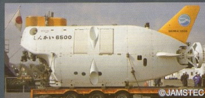
▲▼上の写真が改造工事後、下の写真が改造工事前のものである。比較すると外観では主推進器の変更と後部水平スラストの増設が目立つ。
